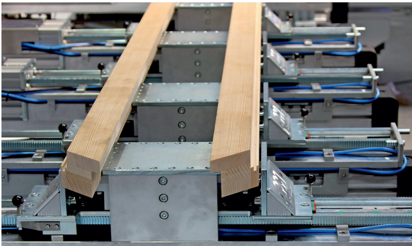
/ Türblind- und Blockrahmenfertigung auf der BMG 511: Moderne Maschinentechologie trifft durchdachte Spannkonzepte.
