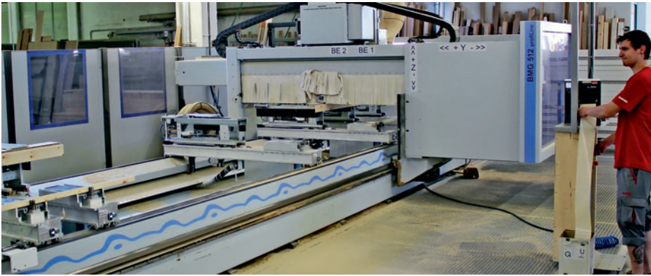
/ Bis ins Detail optimiert ist die BMG 512. Sie verfügt über zwei Spindeln und hochpräzise Spannvorrichtungen für die Komplettbearbeitung der Umfassungszargen und L-förmigen Bekleidungen.
