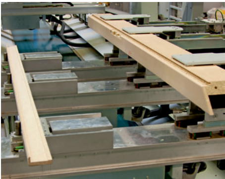
/ Im Detail viel Know-how: Hier zu sehen ist Spezial-Spanntechnologie für die Produktion von Umfassungszargen und Bekleidungen auf der BMG 512.
