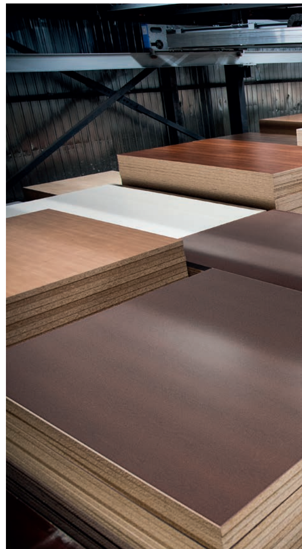
Das vollautomatische Flächenlager von HOMAG optimiert den Materialfluss zwischen Anlieferung und Bearbeitungsmaschine, macht Lagerbestände transparent und sorgt für eine optimale, energieeffiziente Auslastung der Ressourcen.
