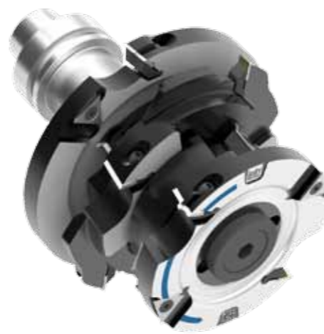
Les ingénieurs Leitz ont incorporé dans le développement du nouveau ProfilCut Q Premium, des notions de simplification de la manutention. Les coupes périphériques et principales peuvent être changées dans le jeu assemblé. (Photo Leitz)
