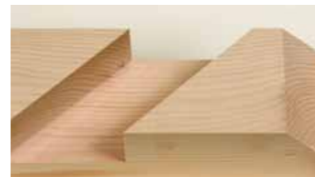
Pas d'éclats, ni de traces de fraiseuse: le porte outil HeliCut est convaincant par sa qualité de coupe suite aux multiples tests effectués (Photo: Leitz)
