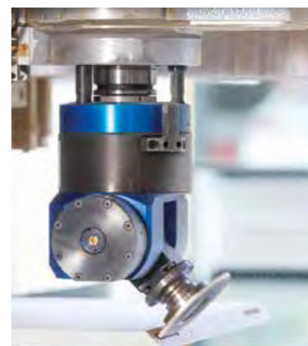
Fraisage d'une rainure profilée par le système P
