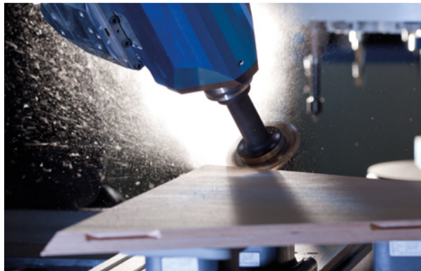
U nového stroje CENTATEQ P-210 volí uživatel mezi hlavami se 3, 4 a 5 osami. Od nynějška je dokonce možné i olepování.
