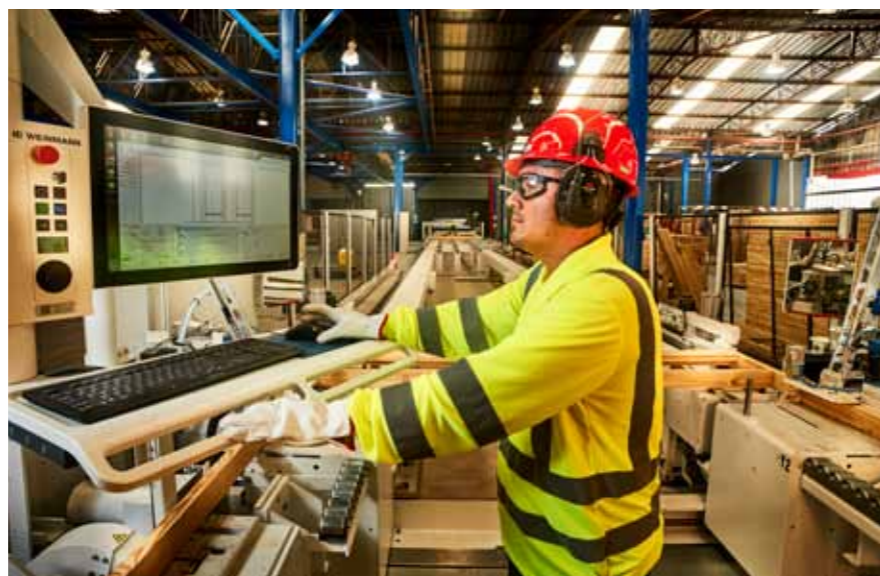
Bilder Seite 42: Mit der Riegelwerkstation werden die Riegelwerke automatisiert hergestellt.
