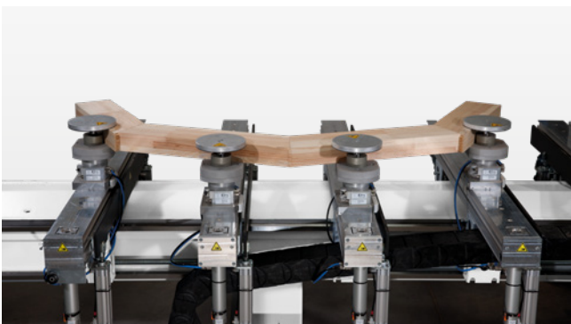
Usinage d'éléments plein cintre, de portes et de pièces de surface
