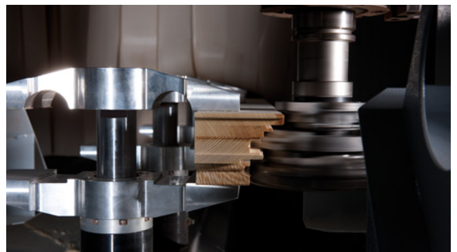
Broches de fraisage à refroidissement liquide avec régulation vectorielle
